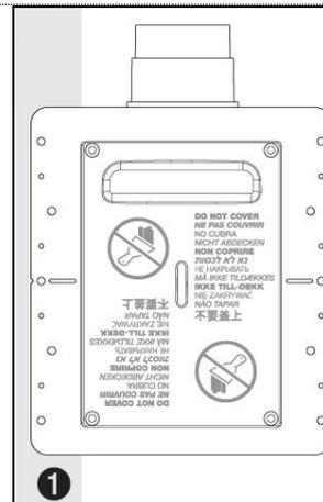
Consigliamo di installare un altro telaio di supporto ❷ nella parte opposta per garantire che la presa sia perfettamente in posizione
