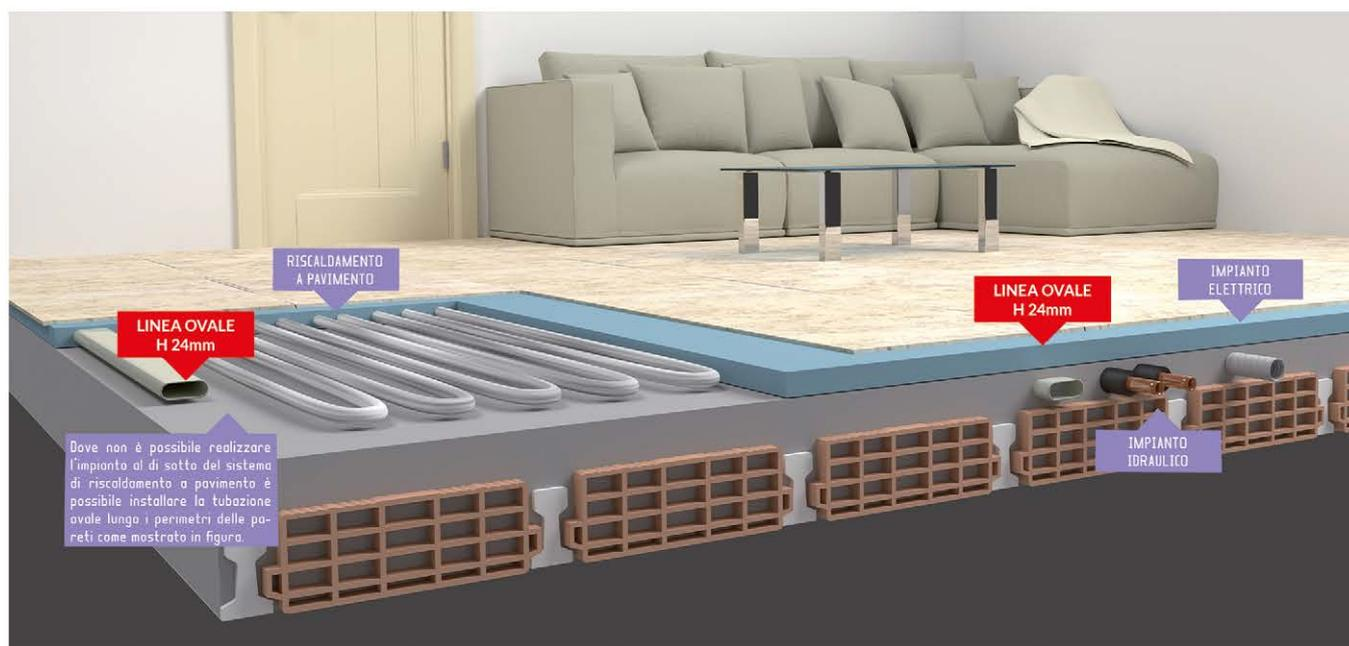
Spesso la presenza del sistema radiante posto all'interno del sottofondo implica spessori più contenuti per tutta l'impiantistica domestica (elettrica, idraulica, aspirazione)
